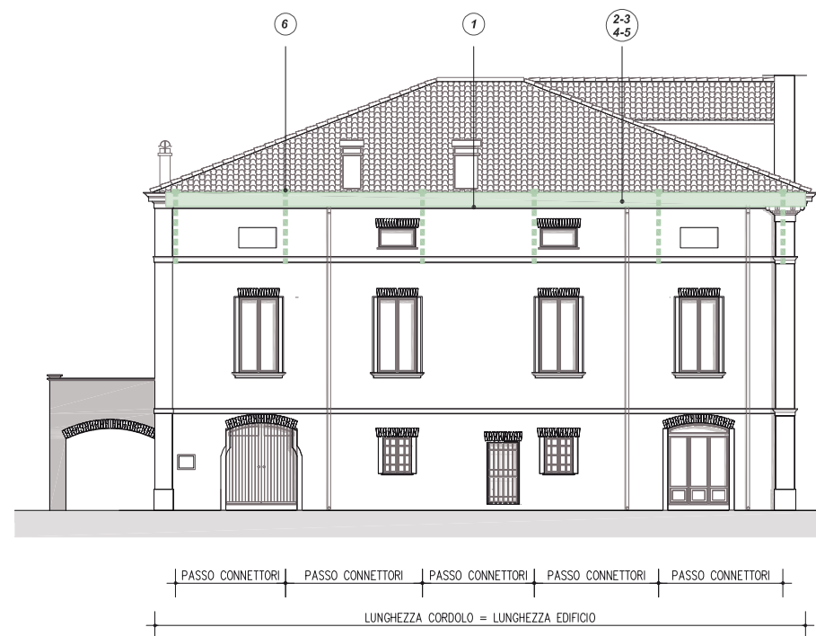
PROSPETTO B-B' RINFORZO DI PORZIONI DI FABBRICATO MEDIANTE CORDOLO IN MURATURA ARMATA
