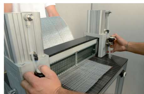
4 Piegatura del tessuto in fibra d'acciaio GEOSTEEL.
